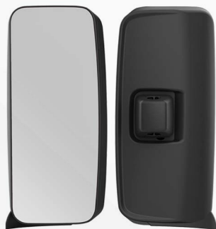
M029H - Espelho avulso Lado Esquerdo Espelho Convexo Versão Manual Nº Original: A0028101316
