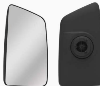
V977E - Espelho avulso Lado Direito Espelho Convexo Elétrico c/ Desembaçador
